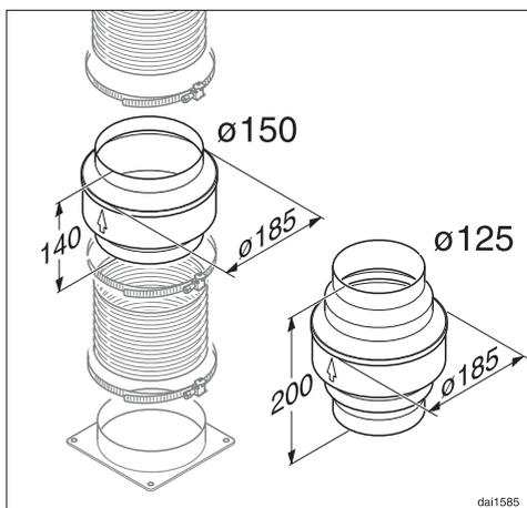
Кроме изоляции воздуховода рекомендуется установка устройства защиты от попадания конденсата, в котором собирается и испаряется образующийся конденсат.
