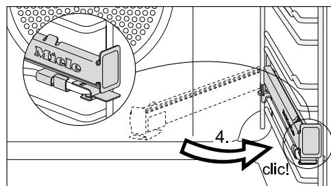
■ Отведите телескопическую направляющую FlexiClip назад и зафиксируйте её на верхней опоре до слышимого щелчка (4).
