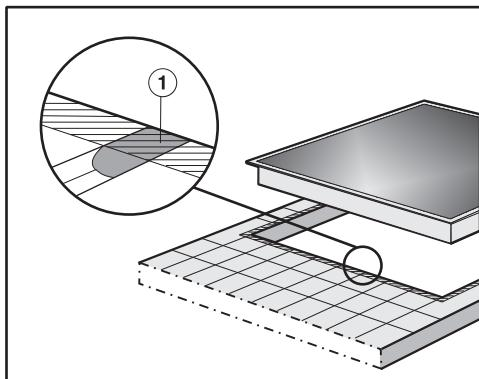
Стыки ① и заштрихованная область под поверхностью панели конфорок должны быть гладкими и ровными, чтобы панель лежала ровно и уплотнение под кромкой верхней части прибора обеспечивало герметизацию столешницы.
