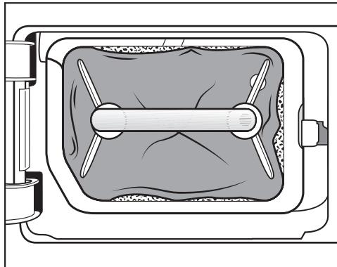
Края цокольного фильтра прилегают неплотно, и он деформируется. В местах, где края фильтра прилегают неплотно, в теплообменник попадает ворс. По этой причине теплообменник сильно засоряется, что приводит к повреждению прибора.
