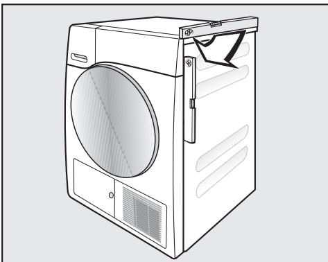
Для обеспечения правильной эксплуатации сушильная машина должна быть выровнена по вертикали. Вращением винтовых ножек сушильной машины можно скомпенсировать неровности пола.
