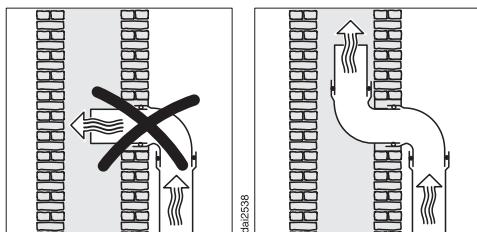
Если вытяжной канал отводится в вентиляционную трубу, то входной штуцер должен быть направлен в сторону потока воздуха.
