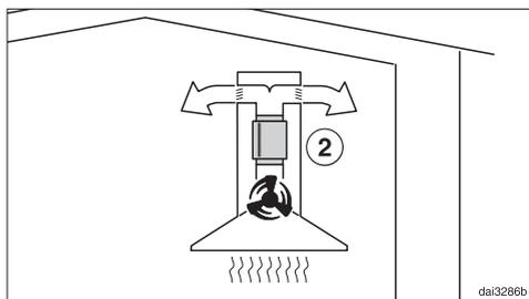
В режим рециркуляции шумоподавитель устанавливается между выпускным патрубком и поворотным патрубком ②. Проверьте область встраивания.
