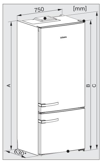
\* Размер без смонтированных проставок для соблюдения расстояния от стены. При использовании прилагаемых проставок глубина прибора увеличивается на 35 мм.
