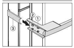
■ Приверните ручку дверцы обоими передними шурупами ① на противоположной стороне, сначала неплотно.
