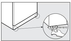
■ Выровняйте прибор, поворачивая передние регулируемые ножки с помощью прилагаемого гаечного ключа так, чтобы он стоял ровно и устойчиво.
