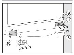
■ Извлеките шарнир дверной петли ⑨ из центра прибора движением наверх.
