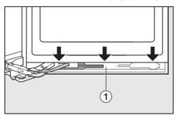
■ Отделите планку ① от амортизатора: вставьте сверху шлицевую отвёртку в выемки и осторожно приподнимите планку.
