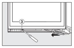
Крепко привинтите промежуточную вставку и дверной амортизатор с помощью шурупа ③.
