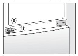
■ В центре прибора поместите шарнир дверной петли (9) с шайбой через кронштейн в нижнюю дверцу прибора (1).
