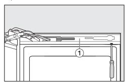
■ Отделите планку ① от амортизатора: вставьте снизу шлицевую отвёртку в выемки и осторожно приподнимите планку.
