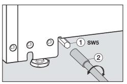
В случае необходимости выровняйте дополнительно задние регулируемые ножки прибора, используя передние регулировочные оси ① (находятся рядом с передними регулируемыми ножками).
