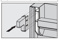
Смонтируйте проставки на задней стороне прибора вверху слева и вверху справа.
