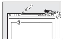
Крепко привинтите промежуточную вставку и дверной амортизатор с помощью шурупа ③.
