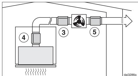
При выносном вентиляторе шумы вентилятора могут выводиться наружу и сводиться к минимуму на кухне. Если шумоподавитель устанавливается перед выносным вентилятором ③, на кухне уменьшаются шумы. Если воздуховод длинный, шумоподавитель должен устанавливаться на выпускном штуцере кухонной вытяжки ④.
