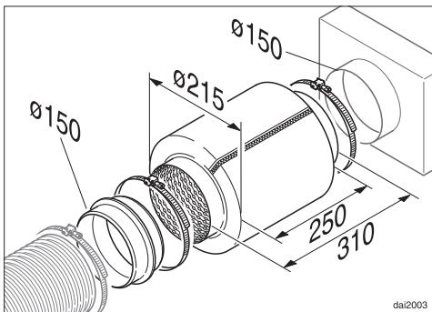
Для дополнительной звукоизоляции с внешней стороны в воздуховоде можно установить шумоподавитель (дополнительно приобретаемая принадлежность).
