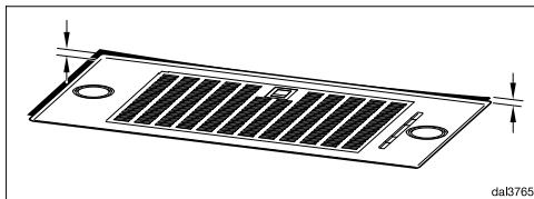
Если поверхность установки неровная и, следовательно, затрудняет установку заподлицо, раму можно дополнительно подогнать под размеры.
