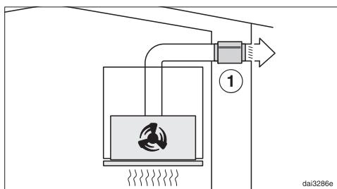
В режиме отвода воздуха шумоподавитель уменьшает внешние шумы, которые могут проникать на кухню через воздуховод (например, шум улицы). Для этого шумоподавитель должен располагаться перед выходным отверстием воздуховода ①, как можно ближе к нему.
