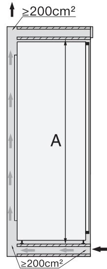
\* Заявленный расход электроэнергии рассчитан для глубины ниши 560 мм. В нише глубиной 550 мм прибор будет полностью работоспособен, однако расход электроэнергии немного увеличится.
