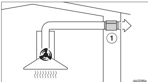
В режиме отвода воздуха шумоподавитель уменьшает внешние шумы, которые могут проникать на кухню через воздуховод (например, шум улицы). Для этого шумоподавитель должен располагаться перед выходным отверстием воздуховода (1), как можно ближе к нему.
