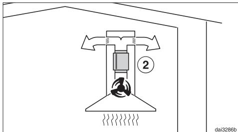
В режиме рециркуляции шумоподавитель устанавливается между выпускным патрубком и поворотным патрубком (2). Проверьте область встраивания.
