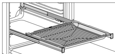
■ Задвиньте универсальный противень с лежащей на нём решёткой для выпечки и запекания на телескопические направляющие FlexiClip. При задвигании решётка для выпечки и запекания автоматически скользит между опорами над телескопическими направляющими FlexiClip.
