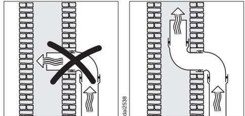
Если вытяжной канал отводится в вентиляционную трубу, то входной штуцер должен быть направлен в сторону потока воздуха.
