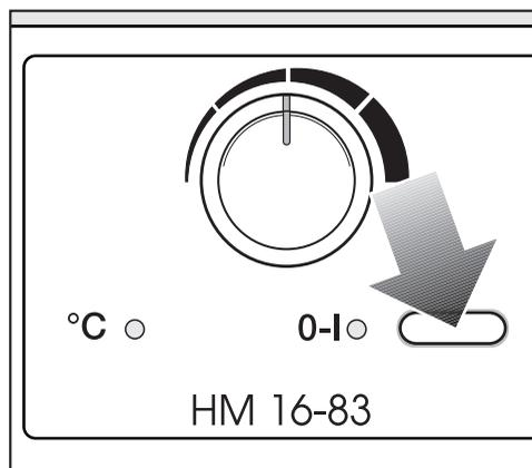
Гладильная машина включается и выключается выключателем **I-O** "Вкл-Выкл".
