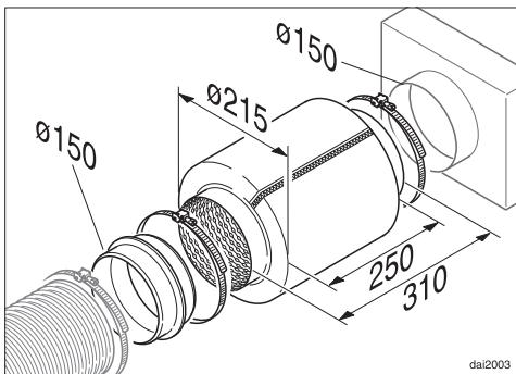
Для дополнительной звукоизоляции с внешней стороны в воздуховоде можно установить шумоподавитель (дополнительно приобретаемая принадлежность).
